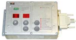
Bedienung über Terminal T-1000 Pocket (B)175x(H)120x(T)55 mm
